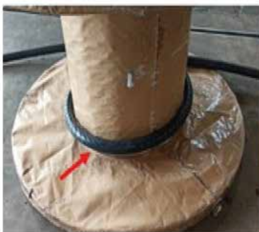
Ensaio de dobramento conforme normas ABNT/NBR 7287 e 9511
